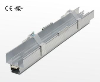
Le profilé type PNR-11154/2 convient pour les applications industrielles générales. Si vous optez pour ce profilé, vous ne devez accrocher aucune gouttière de câbles séparée. Veko équipe de série son profilé d'une gouttière de 111 x 54 mm et d'une cloison de séparation, d'un câble plat 7 x 2,5 mm², de pattes de suspension, raccords et cloisons de fond. Il est également possible d'intégrer 2 groupes d'éclairage dans un même câble plat, par exemple pour un éclairage de secours (certifié KEMA).
