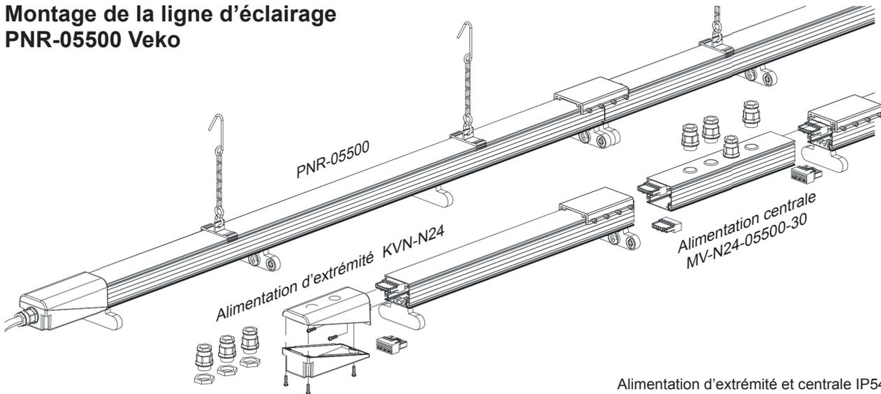
Alimentation d'extrémité et centrale IP54 exécution KVN-N24 et MV-54-05500-30 respectivement.
