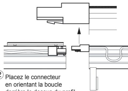
② Placez le connecteur en orientant la boucle derrière le dessus du profil
